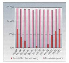
Bild 4 Beispiel anteiliger Tauschfälle durch Überspannungsschäden bei einer Kundeneinrichtung.
