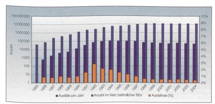
Bild 2 Ausfallraten einer DIV-Baugruppe durch mangelhaften Überspannungsschutz.
