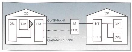
Bild 1 Beispiel des Aufbaus eines Zugangsnetzes (Access-Network).
