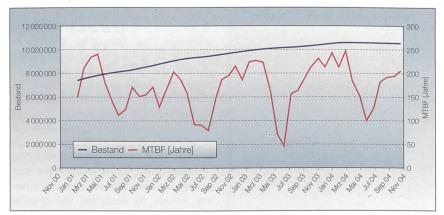
Bild 3 Beispiel jahreszeitlich bedingter Schwankung der Fehlerhäufigkeit bei NT.
