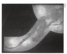
Dampf-Wasser-Strömung bei 5 Megapascal (50-facher Normaldruck) und 264 °C.
