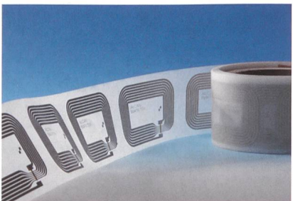
Die Herstellverfahren für RFID-Antennen in gedruckter Form ermöglichen effizientere Produktionsprozesse.
