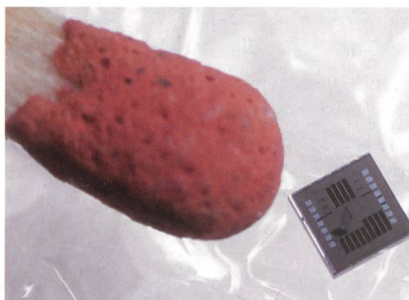
Der Spannungswandler IC kann mit minimalen Eingangsspannungen ab 20 mV arbeiten.
