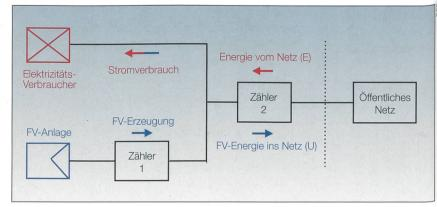
Bild 1 Stromflüsse zwischen Netz und FV-System – Modus «Selbsterzeuger».
