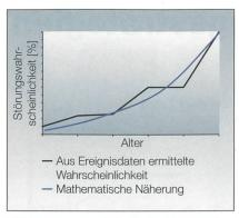
Bild 2 Zustandsmodell – Abhängigkeit der Ausfallwahrscheinlichkeit vom Anlagenalter.
