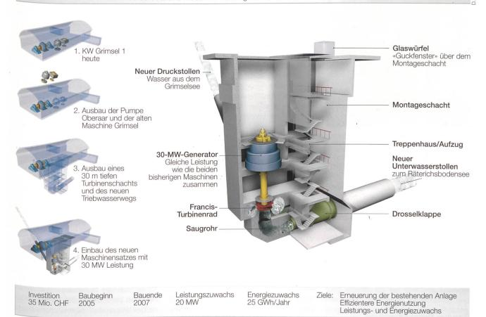
Die Schweiz steht vor Engpässen in der Stromversorgung. Im Investitionsprogramm «KWO plus» werden bestehende Kraftwerke aufgewertet, hier das Kraftwerk Grimsel 1.
