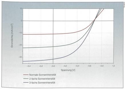
Bild 7 Simulation von intensitätsabhängigen Stromspannungskurven.
