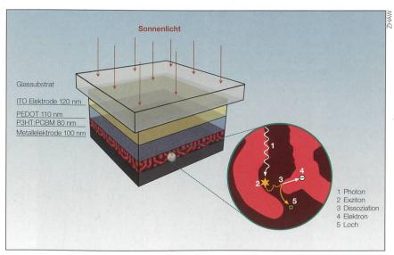
Bild 5 Schichtaufbau einer organischen fotovoltaischen Zelle.
