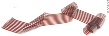
Bild 4 Organische fotovoltaische Zelle auf Plastiksubstrat.
