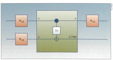
Bild 3 Quantenlogik zur Implementierung des Deutsch-Josza-Algorithmus.
