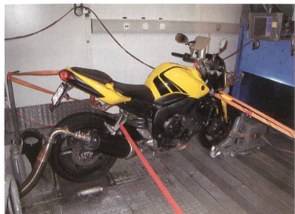
Ein Euro-3-Motorrad mit Baujahr 2006 beim Abgas-test der Empa.
