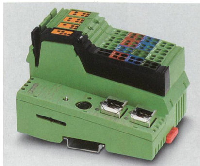
Inline-Controller mit Ethernet-Schnittstelle aus der 100er-Serie von Phoenix Contact.
