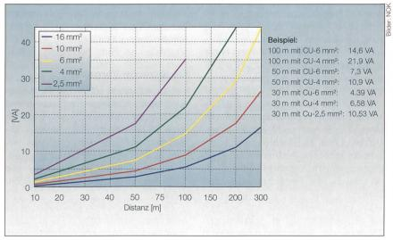
Bild 2 CU-Widerstände - Messleitungen Stromkreise 5 A.
