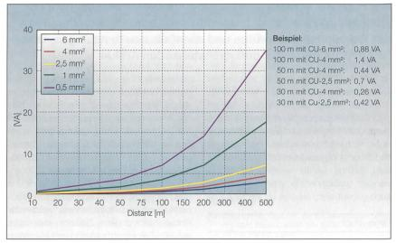
Bild 1 CU-Widerstände - Messleitungen Stromkreise 1 A.
