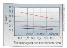
Bild 2 Der Reflexionsgrad ist bei aussenliegender Beschattung klar am höchsten, deshalb ist ein aussenliegender Sonnenschutz bei Fassaden mit hohem Glasanteil zwingend. Der g-Wert ist der Gesamtenergiedurchlassgrad, bestehend aus Reflexions-, Absorptions- und Transmissionsanteilen.
