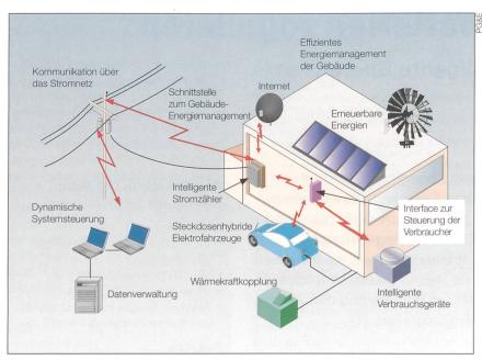
Bild 2 Schematische Darstellung eines Smart Grids.
