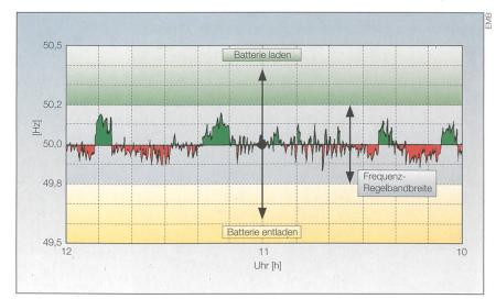
Bild 4 Netzstabilisierung mit einer Batterie.
