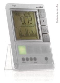
Bild 3 Beispiel eines In-Home-Displays.
