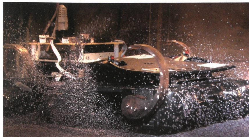
Wenn der Roboter auf der Mohn-Teststrecke seine Beine zu schnell dreht, kommt er nicht mehr vorwärts.
