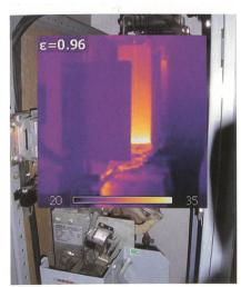
Kombination IR-Bild und Realbild der Flir i60 von Distrelec.
