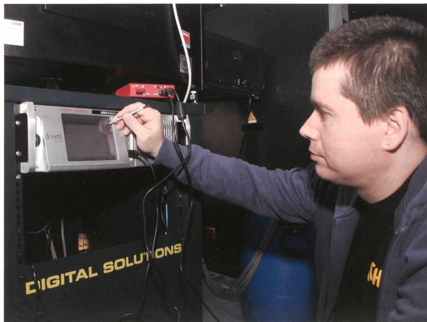
Daniel Schaufelberger, verantwortlich für die Projektionen im Kinocenter Pathé Westside Bern-Brünnen, kennt sich sowohl in der analogen als auch in der digitalen Technik aus. Mittels USB-Kabel kann er den Film von der Harddisk auf den Digitalserver übertragen und entschlüsseln.
