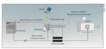
Bild 10 Überwachung des Motors bei Umrichterbetrieb.
