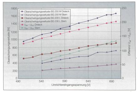
Bild 5 Abhängigkeit der Oberschwingungsverluste von der Umrichtereingangsspannung.
