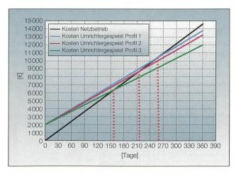
Bild 9 Energiekostenverlauf über die Zeit für den Betrieb am Netz und für den Frequenzumrichterbetrieb. Anschaffungskosten des Frequenzumrichters: 2000 €.
