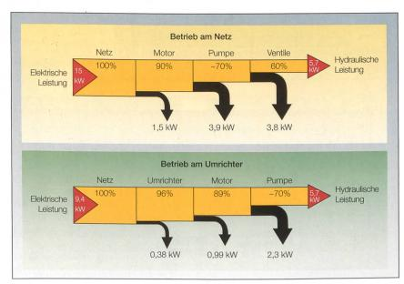
Bild 6 Von der elektrischen zur hydraulischen Leistung.
