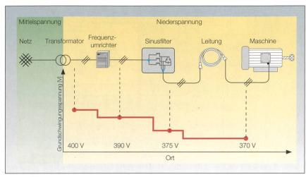
Bild 4 Spannungsabfälle zwischen Netz und Maschine.
