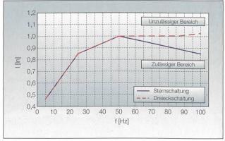
Bild 3 Drehzahlvariable Strombegrenzung aus der EG-Baumusterprüfbescheinigung.
