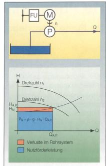
Bild 4 Volumenstromänderung durch Drehzahländerung.
