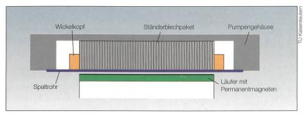
Bild 8 Prinzipieller Aufbau des PM-Spaltrohrmotors.
