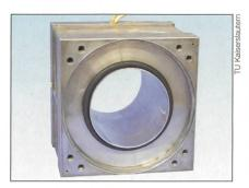
Bild 9 Ständeraktivteil mit Spaltrohr vor der Montage (Funktionsmuster).
