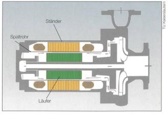
Bild 2 Prinzip der Spaltrohrmotorpumpe.
