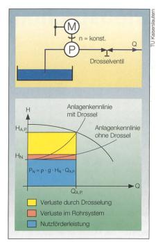
Bild 3 Volumenstromänderung über ein Drosselventil.
