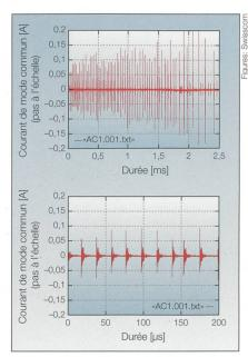
Figure 5 Exemple de bruit impulsif, l'image en dessous montre une vue détaillée.
