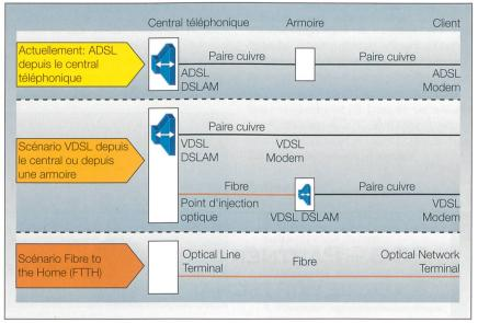
Figure 1 Evolution du réseau de télécommunication.
