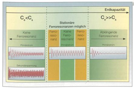
Bild 6 Einfluss der Leistungsschalter-Steuerkapazität.
