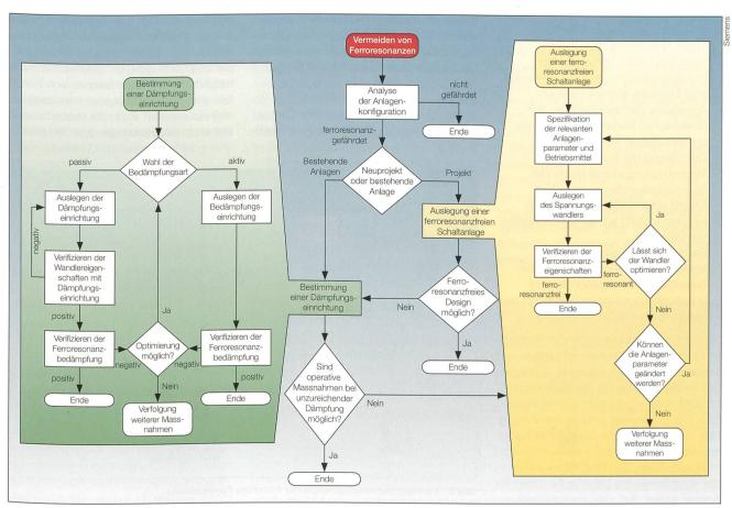
Bild 1 Signalflusspläne für die Analyse und Vermeidung der Ferroresonanz.
