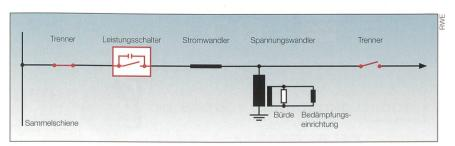
Bild 7 Bedämpfung 1-phasiger Ferroresonanzschwingungen durch Anschluss einer Bedämpfungseinrichtung.
