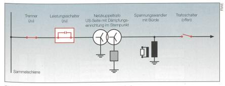
Bild 11 Bedämpfung einer 3-phasigen Ferroresonanzschwingung.
