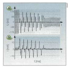
Bild 8 Abklingende Ferroresonanzschwingung durch Dämpfung.
