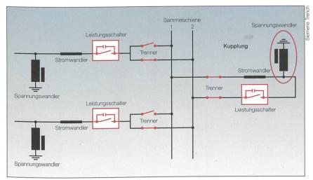
Bild 4 1-poliges Netzersatzschaltbild für 1-phasige Ferroresonanz.
