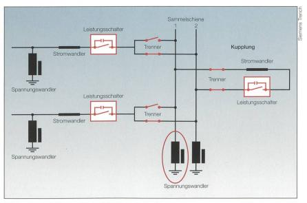
Bild 3 1-poliges Netzersatzschaltbild für 1-phasige Ferroresonanz.
