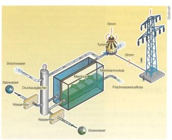
Salz- und Süsswasser werden in ein Becken mit einer halbdurchlässigen Membran geleitet. Osmose bewirkt, dass das Flusswasser in den salzigen Meeresteil eindringt, wo nun ein Überdruck entsteht. Ein Teil des überschüssigen Mischwassers treibt eine Turbine an.
