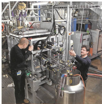
Mit langsamen Myonen, die gezielt in Materialschichten stecken bleiben, lässt sich das Magnetfeld darin auslesen.
