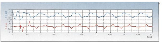
Bild 7 Messung einer 1-phasigen Ferroresonanzschwingung.
