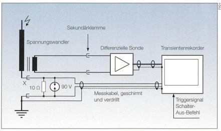
Bild 5 Messung des Stroms durch die Spannungswandler-Primärwicklung und die Spannung an der Sekundärwicklung.
