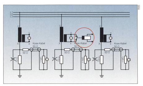
Bild 8 Messung 3-phasiger Schwingungen mit dem Oszilloskop.
