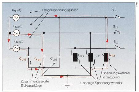
Bild 4 Netzkonfiguration für mögliches Auftreten einer 3-phasigen Ferroresonanzschwingung.
