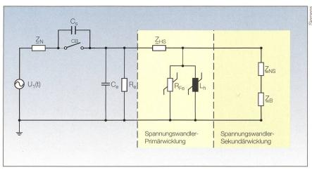
Bild 9 Ersatzschaltbild zur Behandlung einer 1-phasigen Ferroresonanzschwingung.
