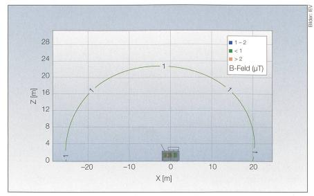
Bild 3 Magnetische Flussdichte inklusive Zusatzfeld der Anschlüsse.
