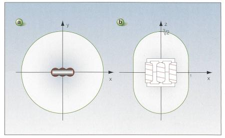
Bild 1 Radienverhältnis bei konstanter magnetischer Flussdichte.
