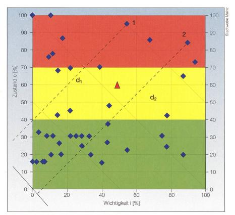
Bild 3 Wichtigkeit - Zustandsdiagramm eines Kabelnetzes.
