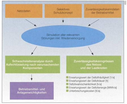
Bild 2 Prinzipieller Ablauf Zuverlässigkeitsberechnung.
