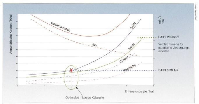
Bild 4 Variieren der Kabelerneuerungsrate.
