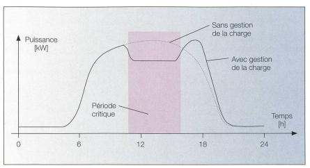
Figure 1 Courbe de charge avec et sans gestion de la charge.
