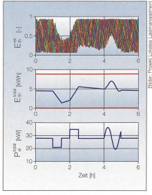
Bild 5 Simulation des koordinierten Betriebs von 500 Kühlgeräten.
