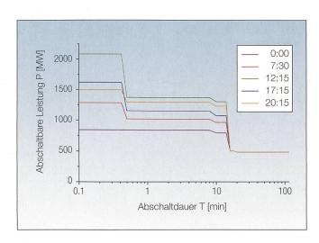
Bild 1 Abschaltbare Leistung von Haushaltsgeräten in der Schweiz bei Komfortstufe A
