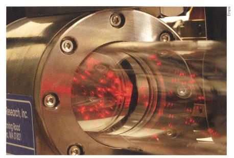
Gasproben fliessen kontinuierlich in die Messkammer des  $\mathrm{CO}_2$ -Isotopenmessgeräts hinein. Je nach Gewicht des Atomkerns absorbieren die Isotope das Laserlicht, und das fehlende Photon wird erkannt. Durch verschiedene Wellenlängen kann man so die unterschiedlichen Isotope zählen.
