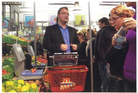
Die intelligente Waage erkennt, wiegt und druckt die Etikette. Die mit der Etikette versehenen Karotten kommen in den intelligenten Einkaufswagen.
