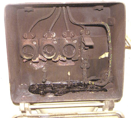
Figure 2 Le monteur-électricien a touché le conducteur polaire et la carcasse métallique avec le tournevis non isolé.
