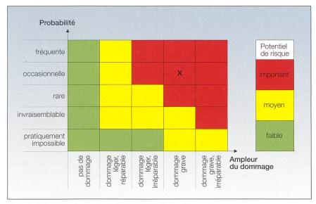
Figure 3 Matrice du risque pour le raccordement d'immeuble.
