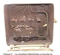
conducteur polaire et la carcasse métallique avec le tournevis non isolé.
