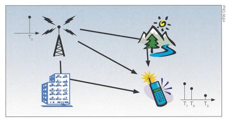
Bild 5 Das empfangene Signal setzt sich aus verschiedenen Teilsignalen zusammen, die von Reflexionen aus der Umgebung herrühren und zur Dispersion des Kanals führen.
