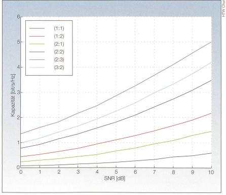
Bild 10 Die simulierte Kanalkapazität bit/s/Hz für verschiedene Antennenkonfigurationen.
