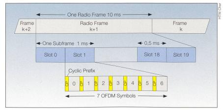
Bild 4 Die Paketstruktur der Luftschnittstelle.
