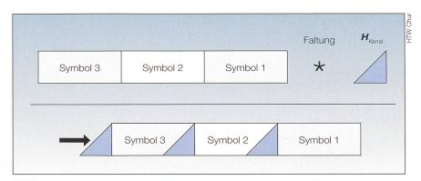
Bild 6 Die 3 gesendeten Symbole werden gefaltet mit der Impulsantwort des Funkkanals, dessen Dispersion durch ein Dreieck dargestellt ist, was zu ISI bei den Symbolen führt.
