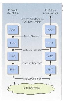
Bild 2 Der Datenfluss durch die verschiedenen Schichten im Downlink, von der eNode B (links) zum Handy (rechts), und die Bezeichnung der Kanäle zwischen den Schichten.
