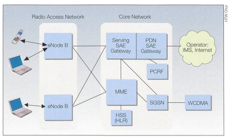
Bild 1 Kontextdiagramm eines LTE-Netzwerks.
