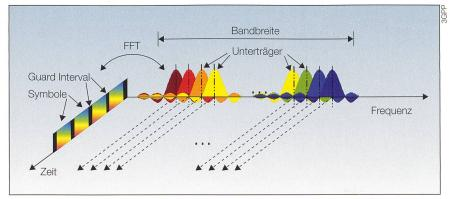
Bild 8 Darstellung des Zeit-Frequenz-Verhältnisses bei OFDM [8].
