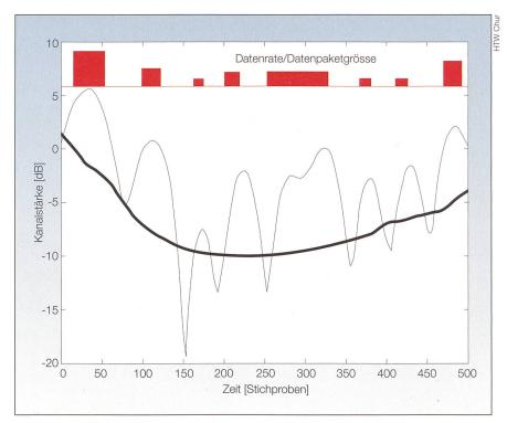
Bild 9 Ein simulierter Mobilfunkkanal zur Verdeutlichung der Kanalstärkefluktuationen.
