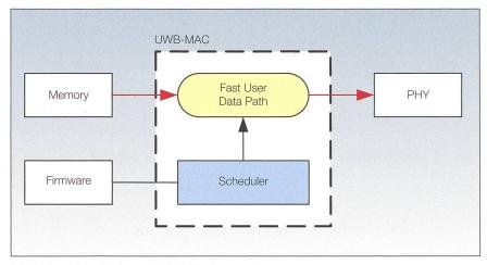
Bild 3 Datenfluss durch den UWB-Media-Access-Controller.
