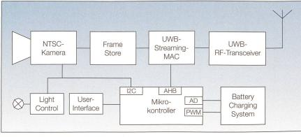
Bild 2 Blockdiagramm der UWB-Kamera.
