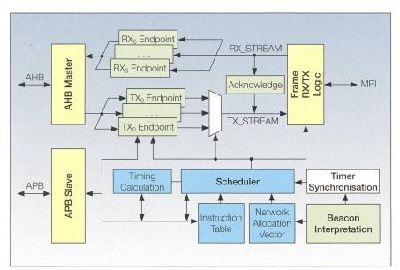
Bild 8 Blockdiagramm des UWB-MAC.
