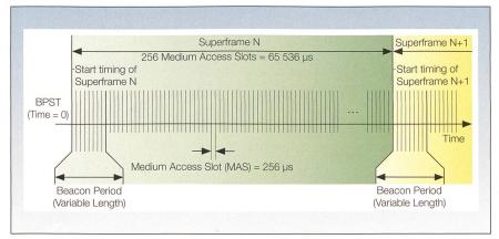
Bild 4 UWB-Superframe mit 256 Media-Access-Slots.
