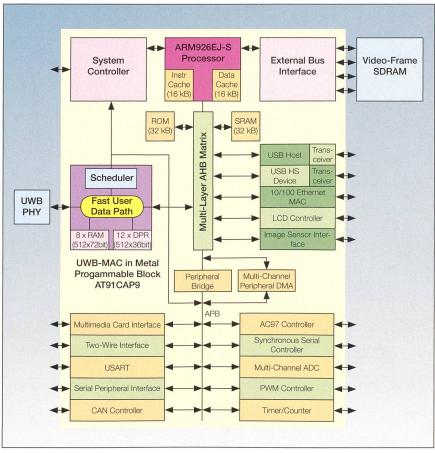
Bild 7 Blockdiagramm des CAP 9.
