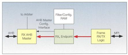
Bild 10 RX-Datenstrom mit Endpunkten.
