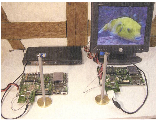
Bild 11 Prototyp für die UWB-Übertragung eines Videostroms.
