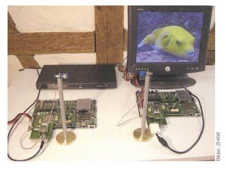
Bild 11 Prototyp für die UWB-Übertragung eines Videostroms.
