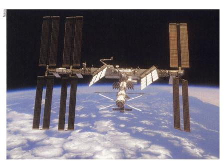
Die Raumstation ISS im Sommer 2008. Neben dem neuen Wohnmodul wird die Crew des Spaceshuttles auch das Sonnensegel rechts unten versuchen zu reparieren. Dieses lässt sich nicht schwenken.
