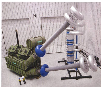
Der 800-kV-Stromrichtertransformator beim Test im Labor.
