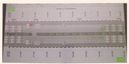
Teilansicht Display des Bereichsrechners «Lüftung» in der Zentrale Reppischtal mitten im Üetlibergtunnel. Schön zu sehen die Anordnung der 2-mal 40 Abluftklappen, der Strahlventilatoren an den Tunnelenden sowie der Axialventilatoren in der Lüftungszentrale Reppischtal (Bildmitte).
