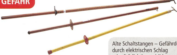
Alte Spannungsprüfer ohne roten Ring, ohne Verlängerungsteil – Gefährdung durch Fehlanzeigen, elektrischen Schlag oder Störlichtbogenbildung
