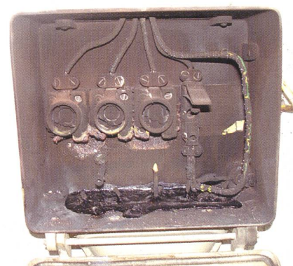
Bild 2 Der Elektromonteur berührte mit dem unisolierten Schraubenzieher Polleiter und Gehäuse.
