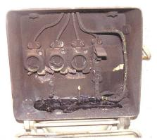
Bild 2 Der Elektromonteur berührte mit dem unisolierten Schraubenzieher Polleiter und Ge-
