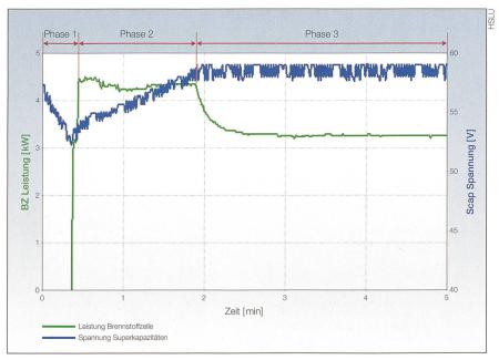
Bild 5 Start der Brennstoffzelle.
