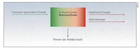
Bild 1 Die Brennstoffzelle wandelt chemische Energie direkt um.
