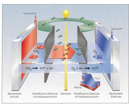
Bild 2 Prinzip der PEM-Brennstoffzelle.
