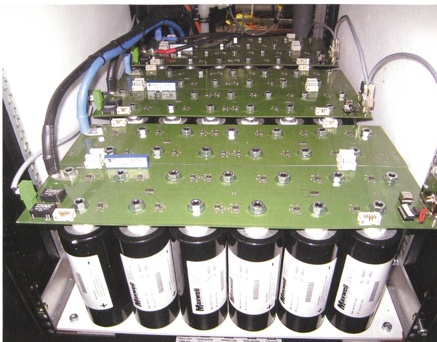
Bild 4 Superkapazitäten liefern kurzfristige Energie.
