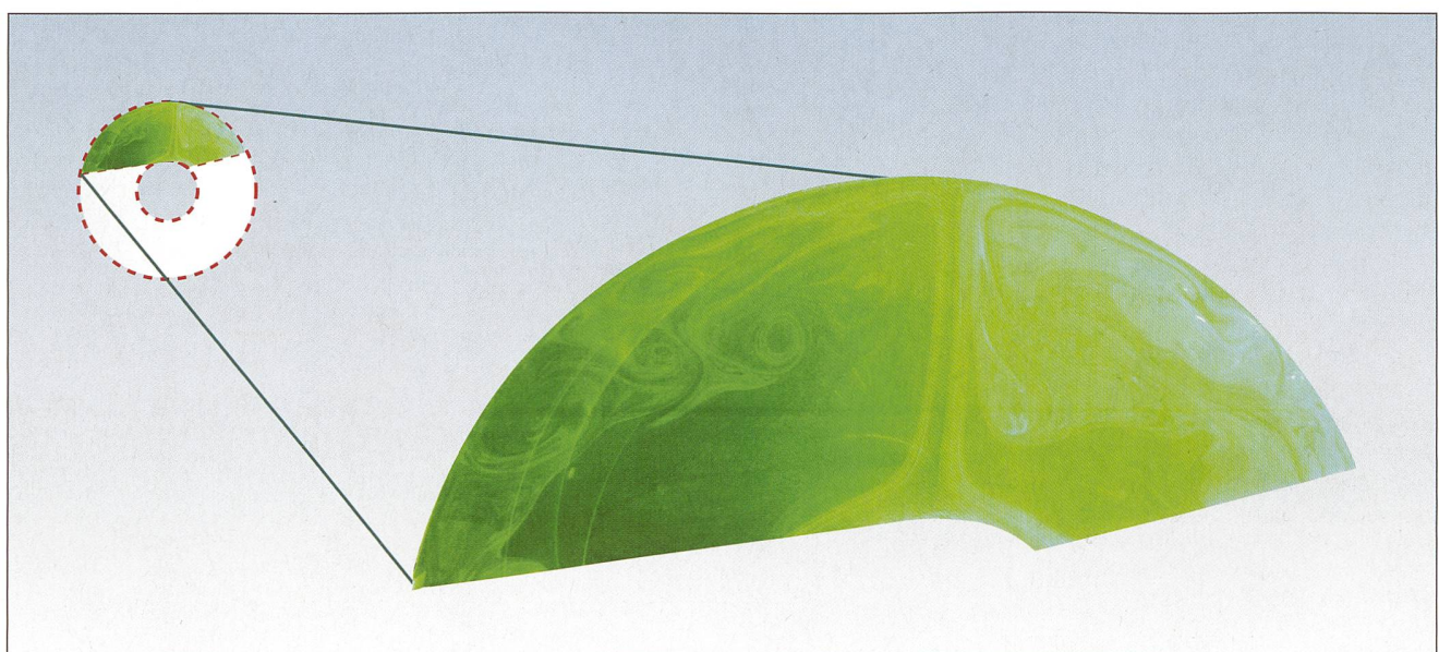
Bild 6 Konvektive Gasströmung oberhalb des warmen Innenleiterrohrs, optisch sichtbar gemacht im gesamten Querschnitt der Sammelschiene (links), und der Ausschnitt oberhalb des Innenleiters (rechts).
