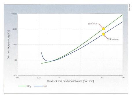
Bild 2 Paschenkurve: Durchschlagspannung in Abhängigkeit des Produkts aus Gasdruck und Elektrodenabstand.
