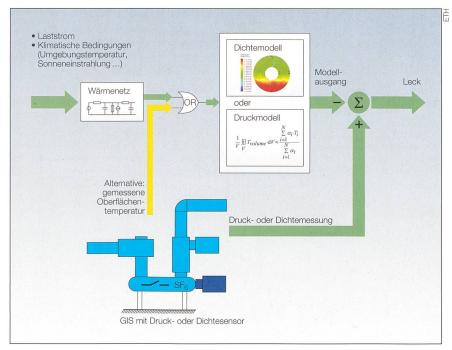
Bild 7 Schema zur modellbasierten Filterung der Messdaten.
