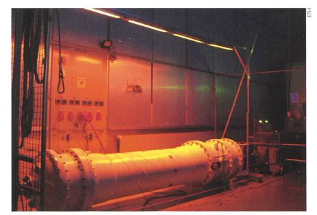
Bild 4 Versuchsstand zur Untersuchung der Temperaturverteilung in einem GIS-Sammelschienensegment.
