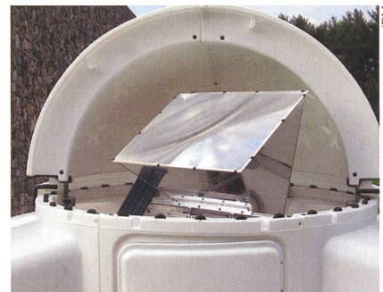
Die Optik konzentriert 2000 Sonnen auf eine Fläche von 1 \text{cm}^2 .
