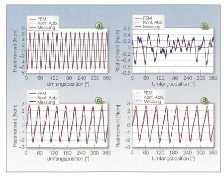
Bild 6 Vergleich des Rastmoments. Mit (a) p=3, (b) p=4, (c) p=4 und eine dynamische Exzentrizität von  $\delta_\epsilon=270~\mu m$ , (d) p=4 und eine statische Exzentrizität von  $\delta_\epsilon=270~\mu m$ .
