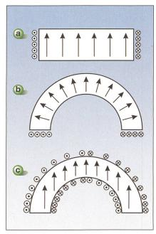
Bild 2 Ersatzstrombeläge verschiedener Magnetformen.
