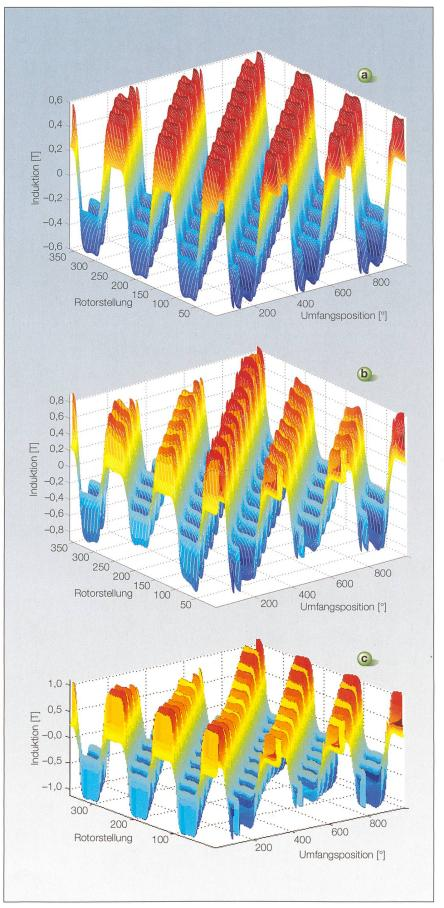
Bild 5 Feldverteilung in verschiedenen Rotorpositionen einer vollständigen Rotorumdrehung. Mit (a) p=3, (b) p=3 und einer dynamischen Exzentrizität von  $\delta_\epsilon=270~\mu m$  sowie (c) p=3 und einer statischen Exzentrizität von  $\delta_\epsilon=270~\mu m$ .
