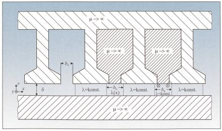
Bild 1 Ersatzanordnung einer realen Nut.
