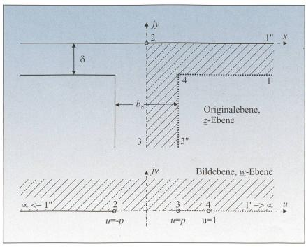
Bild 3 Konforme Abbildung einer halben Nut.
