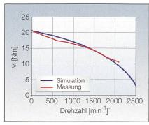
Bild 8 Kennlinie des Motors mit zusätzlicher Energieübertragung.
