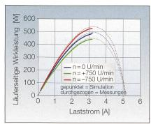
Bild 10 Sekundäre Wirkleistung.
