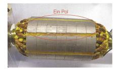
Bild 5 Beklebter Rotor des Funktionsmusters vor der Bandagierung.
