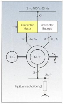
Bild 2 AC-Servoantrieb mit zusätzlicher Energiefunktion.
