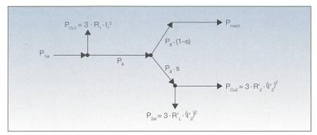
Bild 4 Leistungsfluss bei der Energiefunktion.
