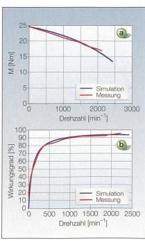
Bild 7 Kennlinie des Motors ohne zusätzliche Energieübertragung.
