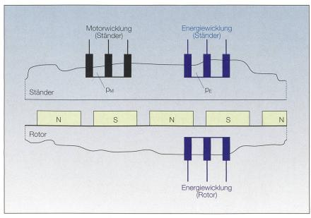
Bild 1 Realisierungsprinzip von Motor- und Energiefunktion.
