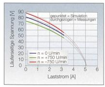
Bild 9 Rotorspannung der Energiefunktion.
