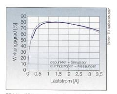
**Bild 11 Wirkungsgrad der Energiefunktion.** Wirkungsgrad der Energiefunktion im Stillstand in Abhängigkeit des sekundären Laststroms.
