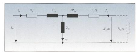
Bild 3 Einsträngiges Ersatzschaltbild der Energiefunktion.
