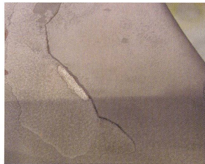
Bild 4 Der Tropfenschlag kann die Beschichtung der Schaufel lösen.
