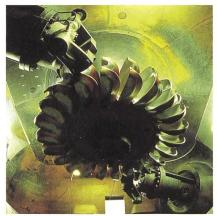
Bild 1 Peltonturbine mit zwei Injektoren.
