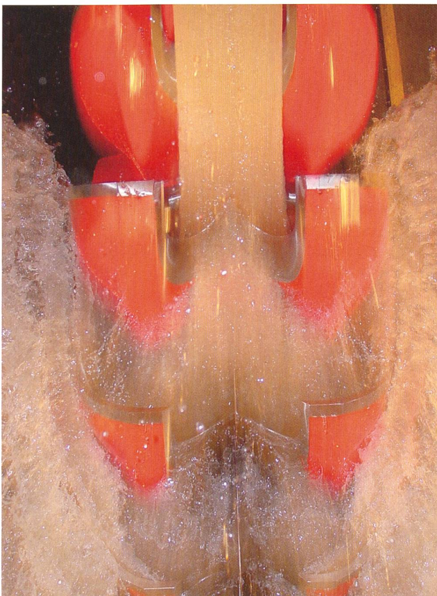
Bild 9 Eine Pelton-turbine im Prüfstand der KWO.
