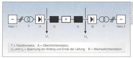
Bild 2 Prinzipskizze der Hochspannungsgleichstromübertragung (HGÜ).
