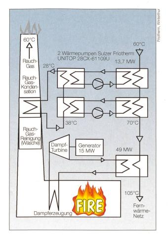
Bild 11 Rauchgaswärmerückgewinnung Kraftwerk Umea (S).
