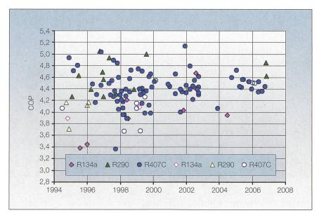
Bild 4 Leistungszahlen (COP) kommerzieller Sole(0 °C)/Wasser(35 °C)-Wärmepumpen. Maximale Wärmesenkentemperaturdifferenz 10 K. Messergebnisse ohne Berücksichtigung des Energiebedarfs für die Sole-Umwälzpumpe. Ausgefüllte Symbole: Scrollkompressoren; leere Symbole: Kolbenkompressoren. Werte aus [4] und [5].
