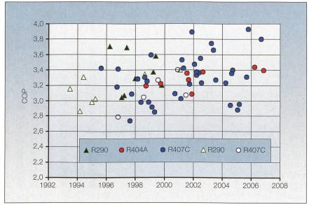
Bild 3 Leistungszahlen (COP) kommerzieller Luft(2°C)/Wasser(35°C)-Wärmepumpen. Maximale Wärmesenkentemperaturdifferenz 10 K. Messergebnisse mit vollständigen Abtauzyklen. Ausgefüllte Symbole: Scrollkompressoren; leere Symbole: Kolbenkompressoren. Werte aus [4] und [5].
