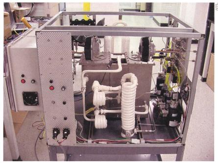
Diese 1,5-kW-Brennstoffzelle für die amerikanische Air Force soll Dieselgeneratoren ersetzen. Sie arbeitet mit einem Festoxid-Brennstoffzellenstapel.
