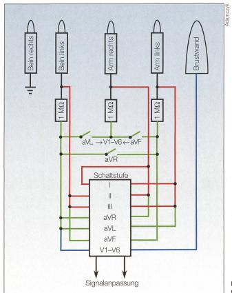
Bild 6 Signalelektroden auf 14 Schaltstufen.
