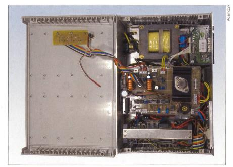
Bild 14 Geöffnetes EKG von oben, hier noch mit internem Netzteil.
