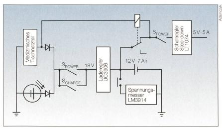
Bild 11 Blockschaltbild der Spannungsversorgung.
