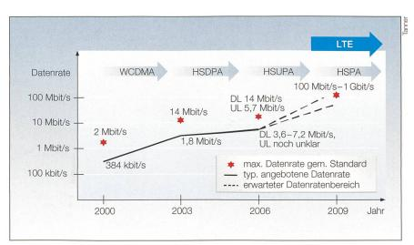
Bild 1 Die Evolution des 3G-UMTS-Mobilfunkstandards und das Datenratenwachstum.
