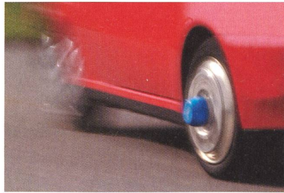
Drehmoment-Messrad RoaDyn P106 von Kistler am Versuchsfahrzeug.
